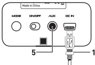
1. Com o cabo USB conectado, ligue o aparelho e pressione o botão Mode até chegar a opção "Audio USB".
