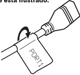
Coloque o marcador "Port 1" ao cabo USB ligado ao terminal USB port 1
